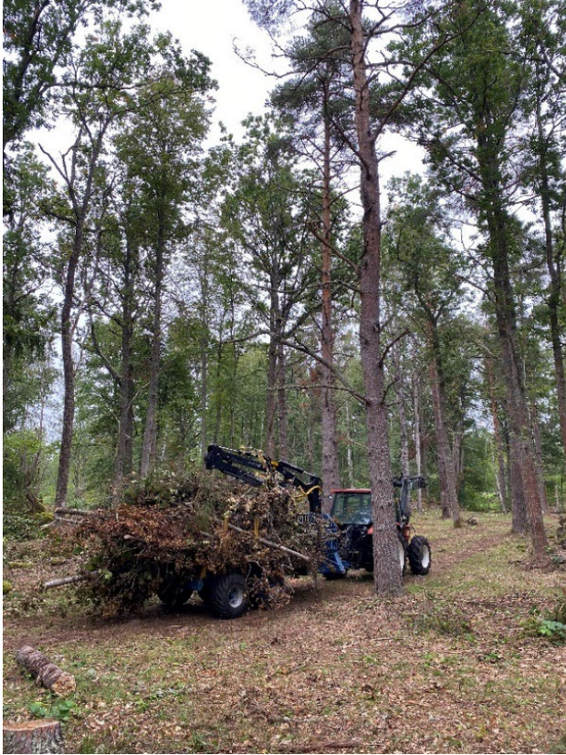
Foto. Utkörning med traktor och vagn. I denna mark var det trångt mellan träd och alla odlingsrösen. Utskotning utfördes under sommaren och inga körskador uppstod.
