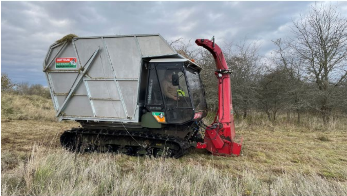
Bild 4. Restaureringsarbete har inväntat denna maskinen som fräser med väldigt lågt marktryck. Arbetet kommer att genomföras sommaren 2024.
