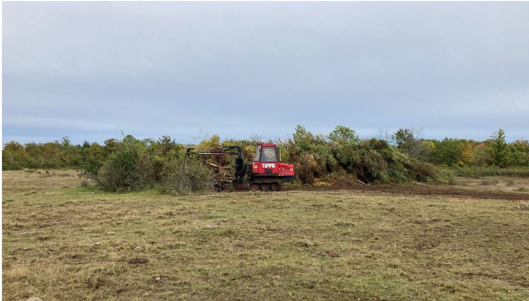
Foto 5. En mindre skotare användes också under hösten 2024 för att köra ut avverkat material. Foto Josefine Östangård
