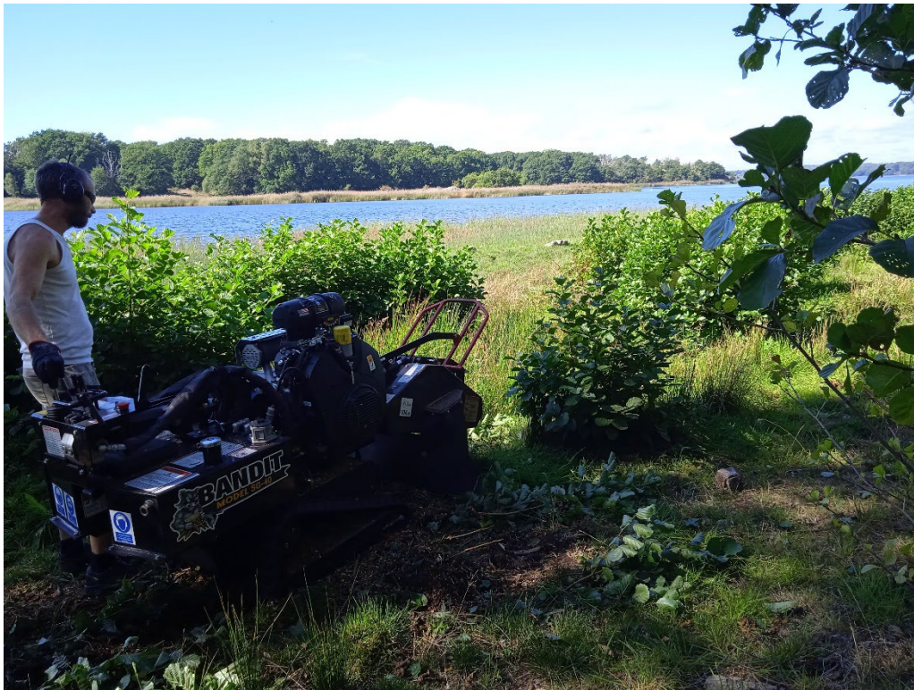
Stubbfräsning av alstubbar 2023.
